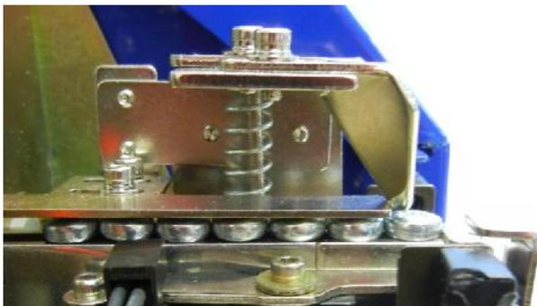
Per la regolazione destra/sinistra allentare le viti **A** e agire sulla vite **E**: in senso orario per spostare il guida inserto verso destra, ed in senso antiorario per spostarlo verso sinistra. Dopo aver trovato il punto corretto fissare le viti **A**.
