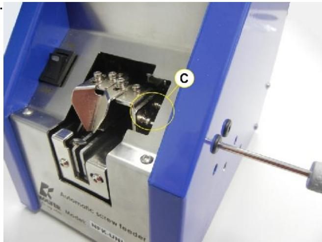
Per regolare l'altezza del blocco copri corsia/guida inserto, allentare le viti **C**, inserendo la chiave esagonale nei fori **D**.
